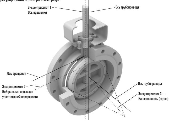
**Эксцентриситет** 1 — отклонение оси вращения от оси трубопровода — уменьшает трение между седлом дискового затвора и уплотняющей поверхностью диска при страгивании и посадке диска в седло, что позволяет проводить простое открывание дискового затвора.
