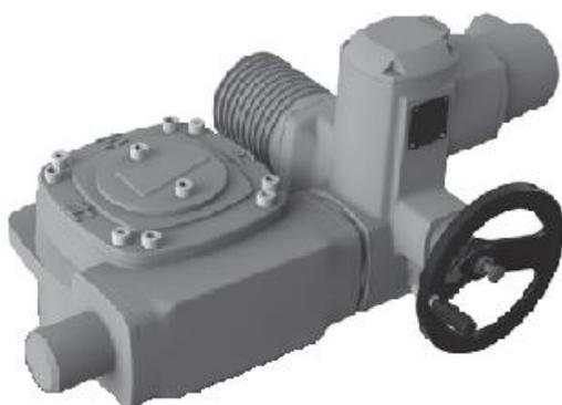
*Комбинация редуктора и многооборотного электропривода AUMA: передаточное отношение позволяет использовать многооборотные приводы меньших размеров, а соответственно и менее дорогостоящих*
