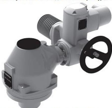
*Комбинация редуктора и многооборотного электропривода AUMA: передаточное отношение позволяет использовать многооборотные приводы меньших размеров, а соответственно и менее дорогостоящих*
